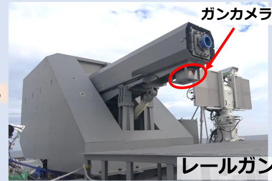
試験艦「あすか」 後部飛行甲板へレールガンを搭載
