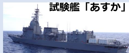
試験艦「あすか」 後部飛行甲板へレールガンを搭載
