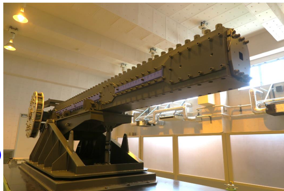
陸上装備研究所にて試作された電磁加速装置 (以降、「レールガン」と呼称)
